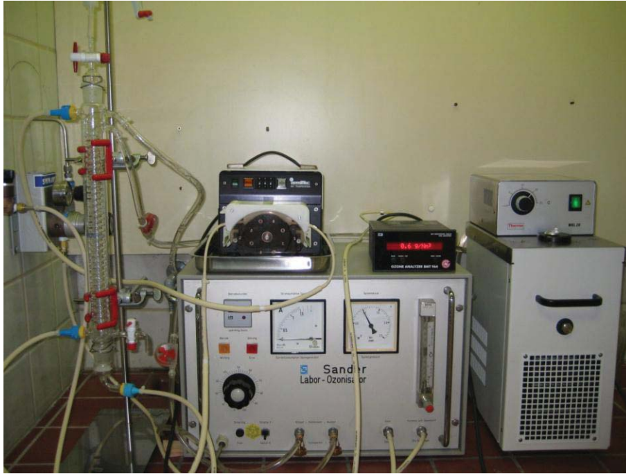
Abbildung 18: Aufbau der Versuchsapparatur für die Ozonisierung der Arzneimittelwirkstoffe
