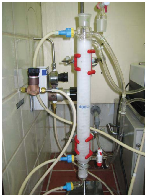
Abbildung 19: Blasensäulenreaktor mit Reaktionslösung
